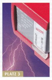
Dehn + Söhne hat neue Kombi-Ableiter entwickelt: Dehn Ven CI sind koordinierte Blitzstrom- und Überspannungs-Ableiter mit einem Ableitvermögen von 25 kA (10/350) und geringem Platzbedarf. Bei Einsatz des zwei Teilungseinheiten breiten Gehäuses entfallen Auswahl und Installation einer Ableitervorsicherung. Dadurch lassen sich kurze Anschlussleitungen realisieren. Die betriebsstromfreie Funktions-/ Defektanzeige gibt sofort Auskunft über die Betriebsbereitschaft.
