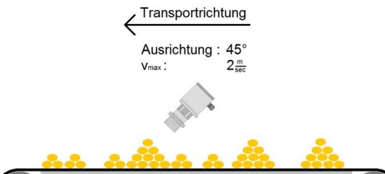
Abb. 1 Montage auf Transportband
